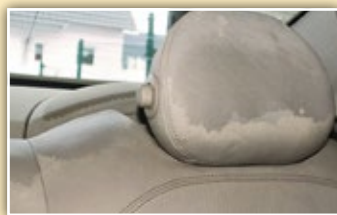
Delamination im KFZ durch Sonne
