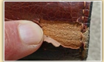
Die Zurichtung platzt im Knickbereich
