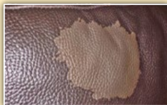
Abrieb im Kopf-Kontaktbereich
