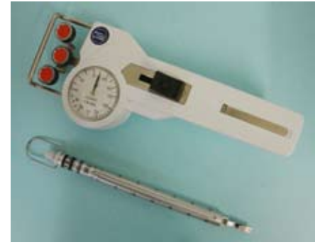
Abb. 5: Fadenspannungsmessgerät und Federwaage zur Überprüfung der Fadenspannungen an der Nähmaschine
