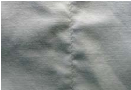
Abbildung 4 verdeutlicht visuell den katastrophalen Nahtausfall. Gekräuselte Nahtoptik nach der Wäsche durch zu hohe Fadenspannung
